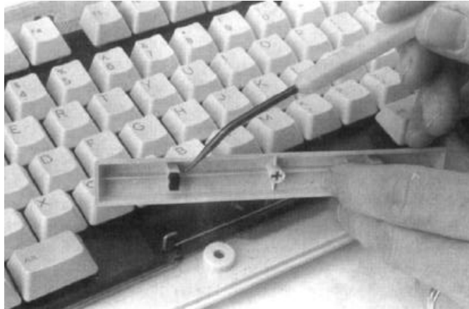
Identificación de soportes de los alambres de retención.
