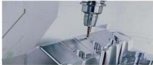
Ball End Mill perfilando un dado complejo
