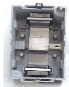
Figura 9(c), Carcaza interna donde se aloja la armadura
