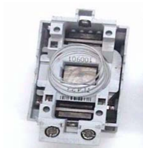
Figura 9(b), carcaza interna donde se aloja el núcleo y la bobina
