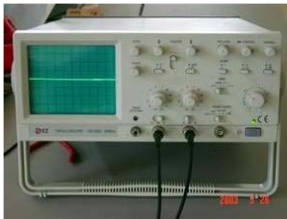
Parte frontal de un osciloscopio EZ digital modelo os-5020 de 20mhz funcionando
