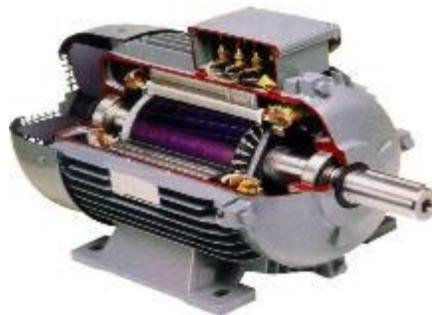
El motor seleccionado fue en base a los requerimientos necesarios para el funcionamiento de la máquina despatadora de chiles, un dato importante es la velocidad requerida para hacer girar el eje con las paletas ensambladas al mismo, la cual es de 115 rpm, esta velocidad es la necesaria para poder realizar el giro para el despatado del chile dentro de la cámara de despatado entonces el motor seleccionado nos permitirá determinar el tamaño de la transmisión a utilizar entre bandas y poleas.
