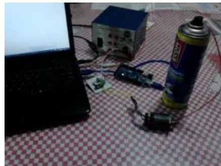
Fig 8 Lubricación de un balero del motor con un lubricante anticorrosivo.
