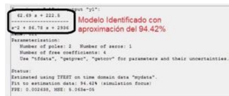
Fig 13 Estimación del modelo del experimento 3 en IDENT de MatLab
