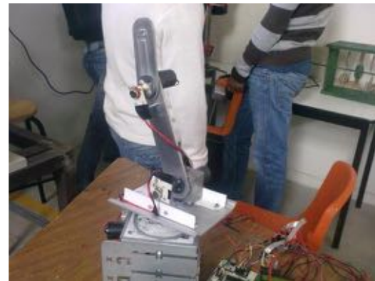
Fig. 9 Planta de tres grados de libertad para el desarrollo de este trabajo de investigación y desarrollo.
