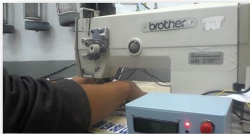
Fig. 3. Máquina de coser con botón de corte manual.
