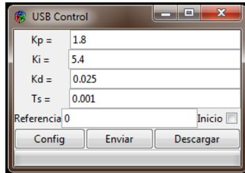
Fig. 7. Interfaz gráfica para manipulación del sistema digital de control.
