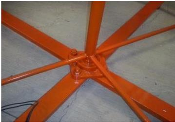
Fig. 9. Eje vertical que soporta el mecanismo
