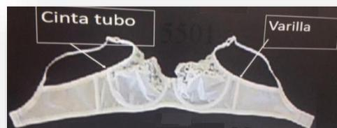
Fig. 2. Distribución de cinta tubo y varilla en el sosten
