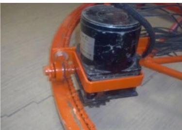
Fig. 10. Mecanismo asociado para la tracción
