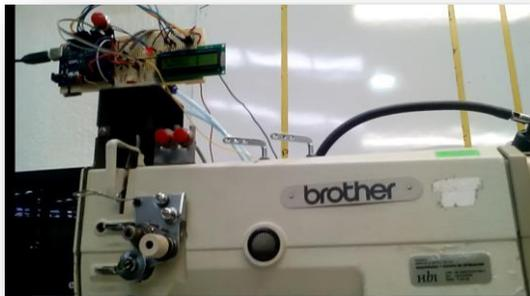
Fig. 5. Sistema automatizado ensamblado a una maquina de coser Brother
