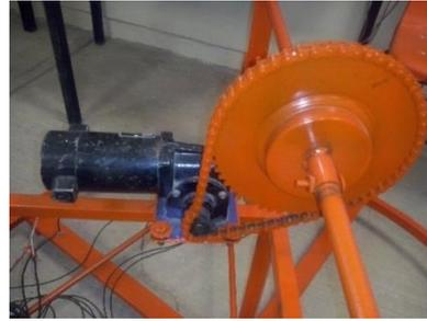
Fig. 11. Mecanismo acoplado para el movimiento de elevación
