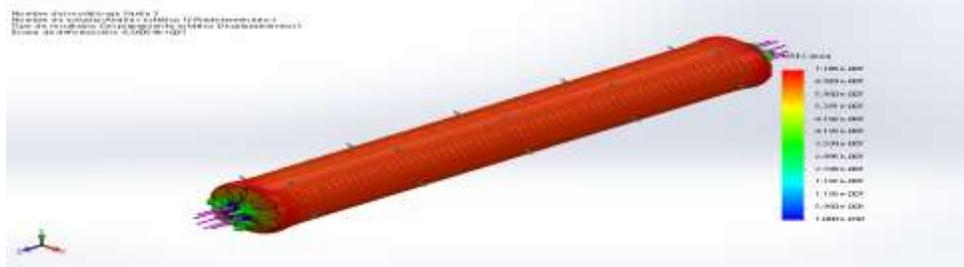
eje llanta 3-Análisis estático 1-Desplazamientos-Desplazamientos1
